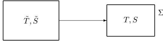
Abb. 2.2: Wärmereservoir, gekoppelt an ein System \Sigma .
